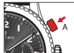
2. Unterbrechung der Zeitmessung durch Betätigen des Drückers **A**. Wiederaufnahme der Zeitmessung durch Betätigen des Drückers **A**. So lassen sich mehrere Zeitspannen messen und kumulieren.
