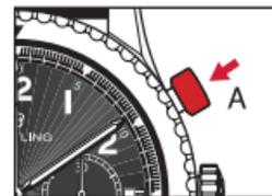
2. 時間計測を中断させるには、ボタンAをもう一度押します。時間計測を再開するには、再びボタンAを押します。このような操作で中断しながら、経過時間を測定することができます(積算計測)。
