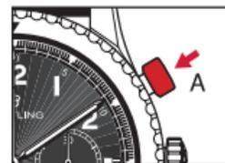
2. Pour interrompre la mesure, appuyer à nouveau sur le poussoir **A**. Pour reprendre la mesure du temps, appuyer sur le poussoir **A**. Il est ainsi possible de cumuler plusieurs temps courts.
