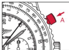
2. Interrumpir la medida presionando nuevamente el pulsador **A**. La medida se efectúa en horas [contador **1**], minutos [contador **2**], segundos y  $\frac{1}{4}$  de segundo [aguja **3**].
