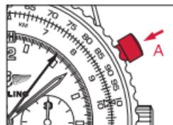
2. Zum Stoppen der Messung erneut Drücker **A** betätigen. Die Messung erfolgt in Stunden [Zähler 1], Minuten [Zähler 2], Sekunden und 1/4-Sekunden [Zeiger 3].
