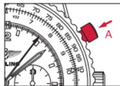
2. クロノグラフを停止させるには、もう一度ボタンAを押します。経過時間は、時(1)、分(2)、1/4秒単位で測定できます(クロノグラフ秒針3)。
