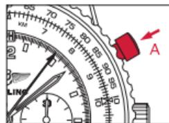
2. Arrêter la mesure en appuyant à nouveau sur le poussoir **A**. La mesure s'effectue en heures [compteur 1], minutes [compteur 2], en secondes et  $\frac{1}{4}$  de seconde [aiguille 3].
