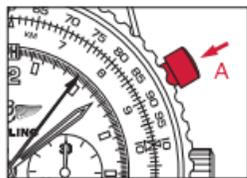
2. 再按一次A按鈕，即可結束計時。計時的結果以小時（計時盤1）、分鐘（計時盤2）、秒鐘與 $\frac{1}{4}$ 秒（指針3）為單位顯示於錶面。
