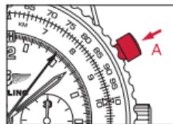
2. Для остановки хронографа еще раз нажмите кнопку **A**. Показания об измеряемом отрезке времени можно прочитать: в часах (счетчик **1**), минутах (счетчик **2**), в секундах и  $\frac{1}{4}$  доли секунды (стрелка **3**).
